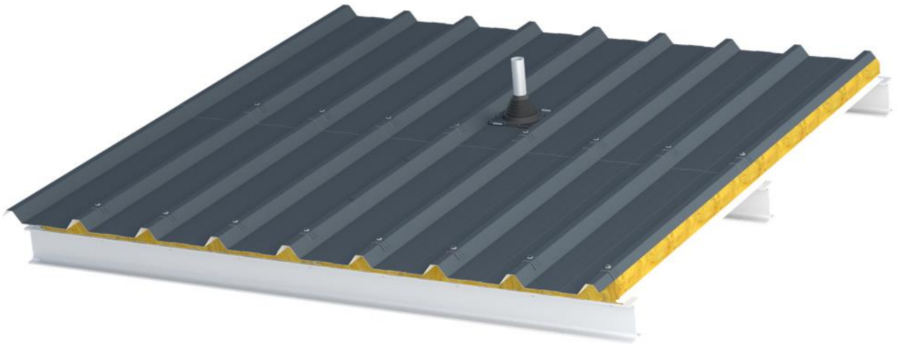
Figure 29 – Pénétration avec manchon d'étanchéité caoutchouc (réalisée en atelier)
